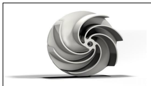
Figura 2. Muestra el modelo para la fabricación del impulsor en poliestireno
