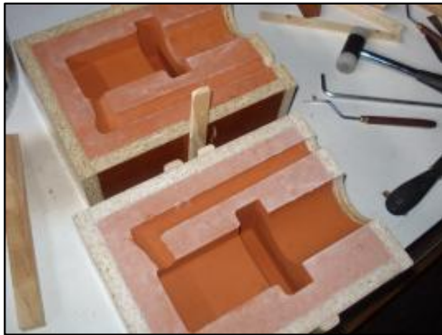
Figura 3. Muestra la base y la tapa del molde de arena
